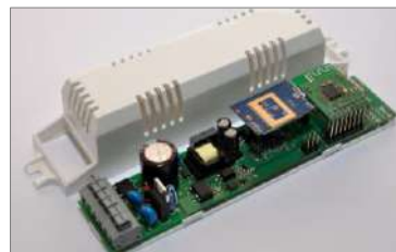
Sterownik inteligentnej oprawy oświetleniowej
