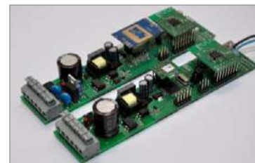
Sterownik inteligentnej oprawy oświetleniowej oraz moduł mostka ZigBee - Bluetooth
